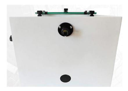
El agujero inferior no tiene ninguna utilidad en este modelo. En la parte inferior de la máquina encontraremos un tapón para el vaciado de la arena. Esto nos ayudará a cambiar la arena o compuesto abrasivo cuando esté en mal estado o cuando deseemos cambiar el grano de abrasión.
